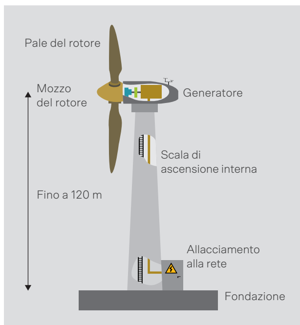
I componenti di un aerogeneratore. Fonte: Verbund/www.stromschule.at
